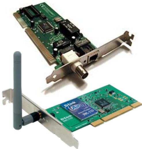
Ogni computer dispone di una scheda di rete (Network Interface Controller – NIC), ovvero una scheda elettronica alloggiata all'interno di un personal computer, server, stampante, router ecc., offrendo le funzioni necessarie per la comunicazione in rete.
